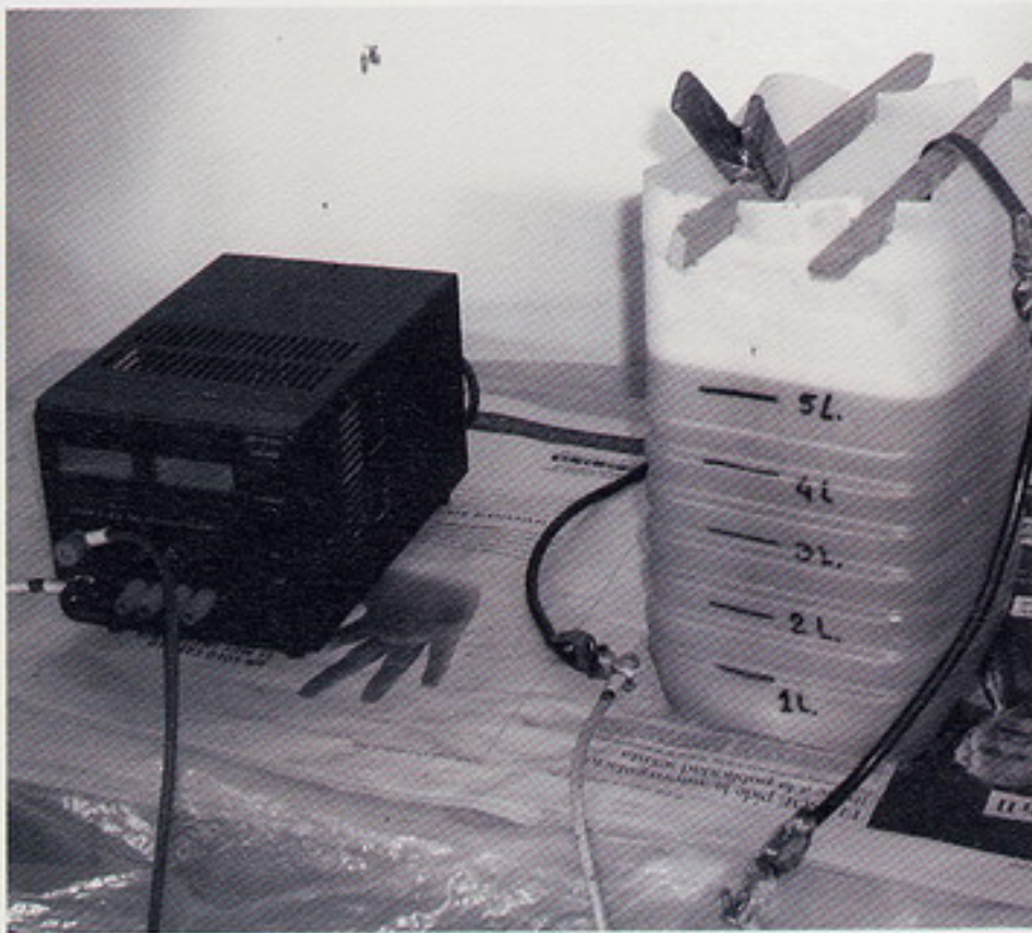
Instalación "casera" y funcional con un rectificador de trenes eléctricos y un bidón de plástico a modo de cubeta vertical.
